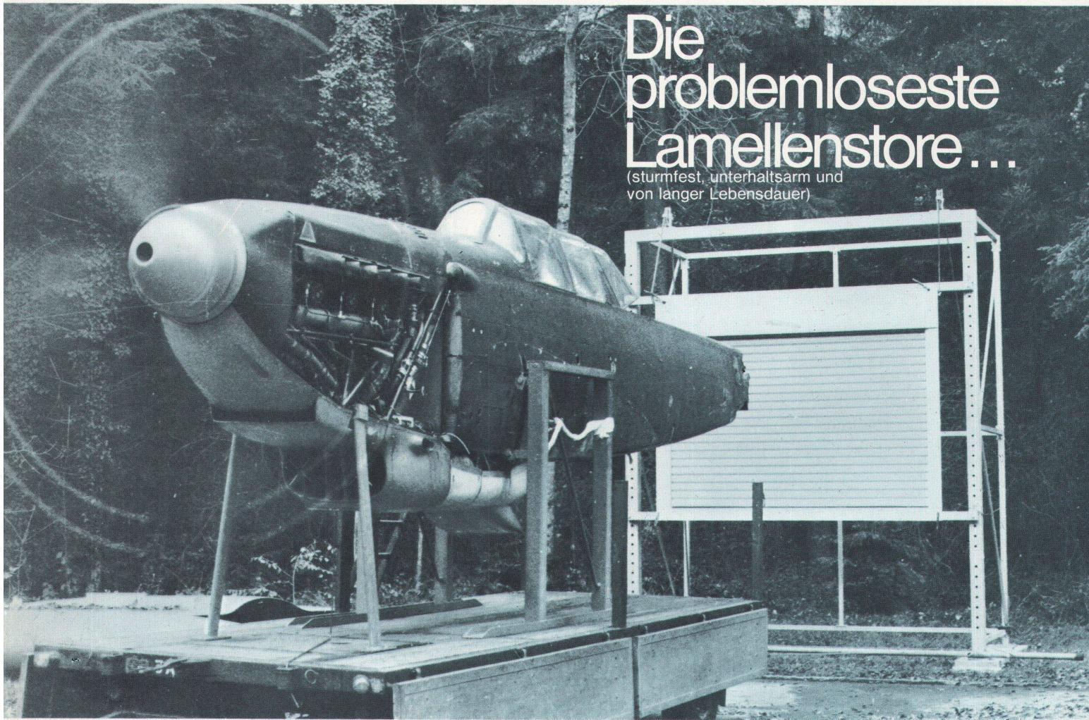
**Versuchsanlage** in Emmen mit C-36 Flugmotor auf freiem Feld zur Nachbildung von Windböen, wie sie in der Natur auftreten. Leistung der Anlage: 105 km/h Windgeschwindigkeit mit starker Turbulenz.
