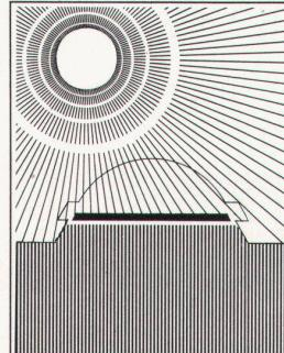
nullux liegt in einem flachen Rahmenelement, das zusammen mit der CUPOLUX-Lichtkuppel auf den Aufsetzkranz gesetzt wird: einfache und schnelle Montage – keine zeitraubende Detailplanung, keine aufwendigen Konstruktionen.
