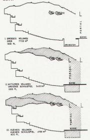
Mit Hilfe von Schallimpulsen wurden die beweglichen Teile der Decke so eingestellt, dass die Primarschallenergie zwischen den einzelnen Plätzen möglichst geringe Unterschiede aufwies. Sie betragen bei der «Oper» von der vierten Reihe im Parkett an für den ganzen Saal lediglich ±2 Dezibel (subjektiv kaum feststellbar). Der Einfluss der Publikumsabsorption ist infolge der ansteigenden Sitze auch im Parkett gering (Messung
