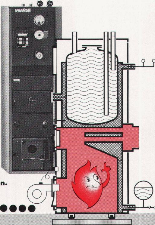
Er wird anschlussfertig verschalt, als komplette Einheit geliefert. Dank seiner geringen Bauhöhe und kleiner Grundrissfläche (er ist schmäler als eine 70-cm-Türe) findet er im kleinsten Raum Platz.
