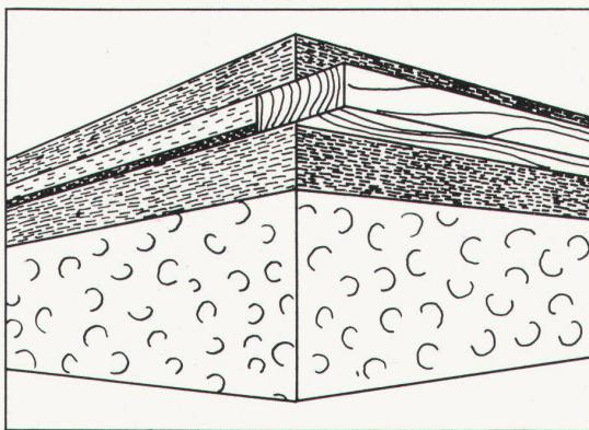
schnitten. Dank der bewährten Verbindungstechnik mittels Federn in den Plattenruten ist die Elementmontage im Einmannsystem einfach, schnell, problemlos. — Die Vorteile: Fugenlose Vollisolation; keine Kältebrücken, kein Energieverlust; Senkung der Isolationskosten ca. 50 %, Heizkostenreduktion 15—20 %; Druckfestigkeit ca. 1400 kg/m<sup>2</sup>; K-Werte zwischen 0,875 und 0,626.
