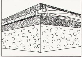
schnitten. Dank der bewährten Verbindungstechnik mittels Federn in den Plattennuten ist die Elementmontage im Einmannsystem einfach, schnell, problemlos. — Die Vorteile: Fugenlose Vollisolation; keine Kältebrücken, kein Energieverlust; Senkung der Isolationskosten ca. 50 %, Heizkostenreduktion 15-20 %; Druckfestigkeit ca. 1400 kg/m<sup>2</sup>; K-Werte zwischen 0,875 und 0,626.
