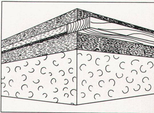
schnitten. Dank der bewährten Verbindungsstechnik mittels Federn in den Plattenruten ist die Elementmontage im Einmannsystem einfach, schnell, problemlos. — Die Vorteile: Fugenlose Vollisolierung; keine Kältebrücken, kein Energieverlust; Senkung der Isolationskosten ca. 50 %, Heizkostenreduktion 15—20 %; Druckfestigkeit ca. 1400 kg/m<sup>2</sup>; K-Werte zwischen 0,875 und 0,626.
