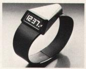
Kategorie B (elektronische Armbanduhr mit Quarzoszillator), 1. Preis: Fridolin Naef, Zollikon ZH. Quarzuhr, Digitalanzeige durch Flüssigkeitskristalle, Stahlgliederarmband, schwarz chromiert, konisches Stahlgehäuse, chromiert, abgewinkelte Anzeige.
