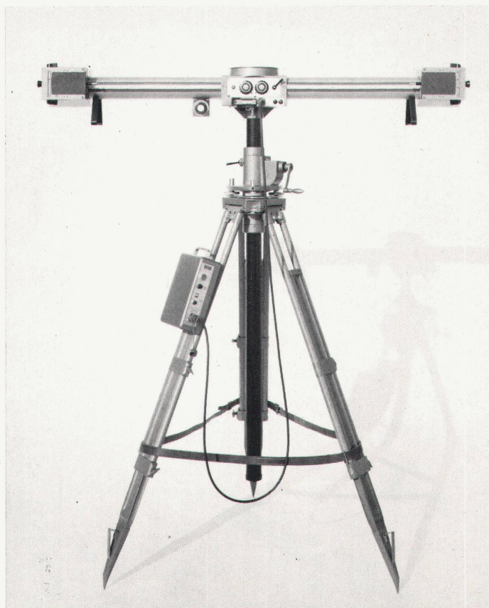
Abb. 6 Individuelle Messkammer: Wild P31, Brennweite 100 mm, Bildformat 4 × 5".
