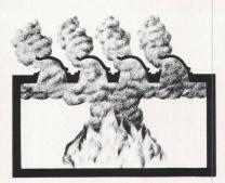
Durch die Dachöffnungen ziehen Rauch, Hitze und Gase ab. Die Frischluftzone über dem Boden gibt der Feuerwehr Sicht und Weg frei.
