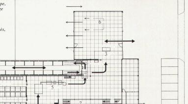
1200×1200 mm, on peut empiler des harasses jusqu'à une hauteur de 1600 mm. L'entrepôt mesure 4,30 m de large, 74 m de long et 23 m de haut; il a une capacité de 800000 bouteilles. A l'aide de dispositif de commande à cartes perforées, chaque palette est mise à sa place. La commande électronique de la machine, dont la hauteur est égale à celle de l'entrepôt, ne permet qu'une déviation minime de la déformation élastique de la construction. Pour la structure portante on a donc fait appel à des
