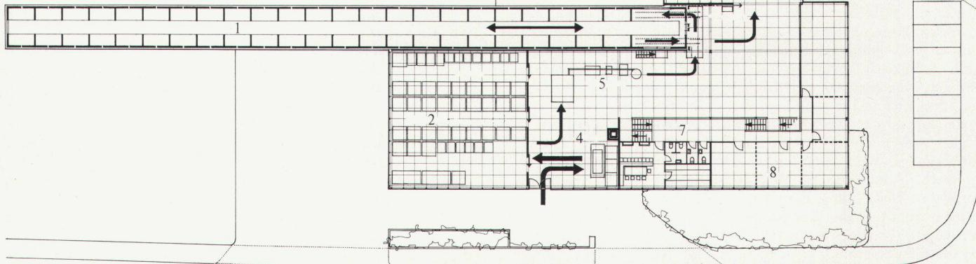
1200×1200 mm, on peut empiler des harasses jusqu'à une hauteur de 1600 mm. L'entrepôt mesure 4,30 m de large, 74 m de long et 23 m de haut; il a une capacité de 800000 bouteilles. A l'aide de dispositif de commande à cartes perforées, chaque palette est mise à sa place. La commande électronique de la machine, dont la hauteur est égale à celle de l'entrepôt, ne permet qu'une déviation minime de la déformation élastique de la construction. Pour la structure portante on a donc fait appel à des
