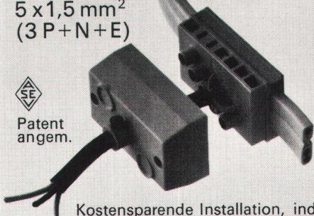
Kostensparende Installation, indem die Anschlussboxen an beliebiger Stelle des Kabels mit einem Schraubenzieher, als einziges Werkzeug, leicht und schnell montiert werden können, da das Kabel weder aufgeschnitten noch abisoliert werden muss.
