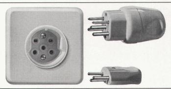
Die Feller-3/5-pol-Universal-Steckdose zum Beispiel bietet unter allen Hausinstallations-Steckkontakten die grösste Freizügigkeit für den Anschluss von Apparaten: Ob Kleinapparate bis 2,2 kVA oder Grossapparate bis 6,5 kVA, sie alle können angeschlossen werden. Ob 220V (2P+E) oder 380 V (3 P+N+E), ob Einphasen- oder Drehstrom, ob in der Werkstatt, dem Labor oder der Küche, die Feller-Universal-Steckdose bietet immer ideale Anschlussmöglichkeiten.
