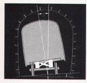
La voiture à caisse inclinable pour permettre le franchissement des courbes à vitesse élevée. L'effet du dévers de la voie est complété par l'action d'un dispositif électromécanique, qui incline la caisse du véhicule vers l'intérieur des courbes, de sorte que celles-ci peuvent être franchies à plus vive allure sans que le confort s'en ressente
