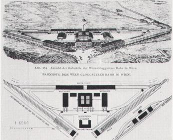
Grund- und Aufriss der Bahnhöfe der Wien-Gloggnitzer Bahn, Zustand 1860, später zum Südbahnhof erweitert. Man beachte die schlossartig symmetrische Anlage mit Springbrunnen im Mittelpunkt. Bildquelle: Geschichte der Eisenbahn, Wien 1897. Plan et élévation des gares du chemin de fer de Vienne-Gloggnitz, en 1860, agrandies plus tard pour former la Gare du Sud. A noter l'agencement symétrique en forme de château et la fontaine au centre.
