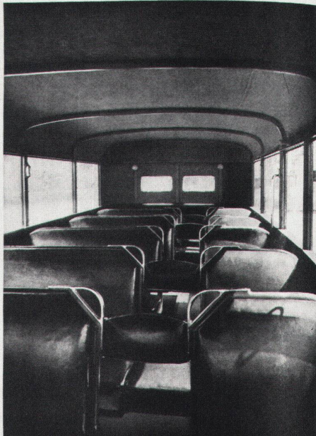
INNERES EINES GESCHLOSSENEN AUTOBUS / SAURER A. G., MASCHINENFABRIK UND GIESSEREI, ARBON Bekannte, einfache Anordnung / Jede Person vollständig mit Aussicht über die Straße, Bäume sichtbar durch die Glasfront der über Eisen verstellbaren Materialien: Leder, Holz, Metall; konform dem Begriffen der Plaisance, Geschwindigkeit, unmittelbarer Beziehung mit der Funktion
