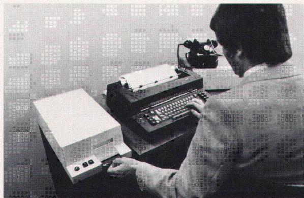
Das ist die Einrichtung, die Sie brauchen, um Computerleistung direkt am Arbeitsplatz zu erhalten: das Terminal IBM CMC (oder ein anderes Terminal), Modem und Telefon. Das Spezielle am Terminal IBM CMC ist, dass es sich zusätzlich als Magnetkartenschreibmaschine einsetzen lässt.
