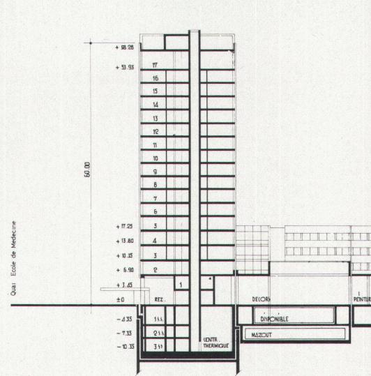
plus courtes. La tour est construite en béton et en métal; les façades isolantes sont en métal. Les dalles en béton reposent sur le noyau central en béton et sur les piliers extérieurs en métal; la façade est en éléments préfabriqués. Des cloisons mobiles permettent une distribution fonctionnelle des locaux.
