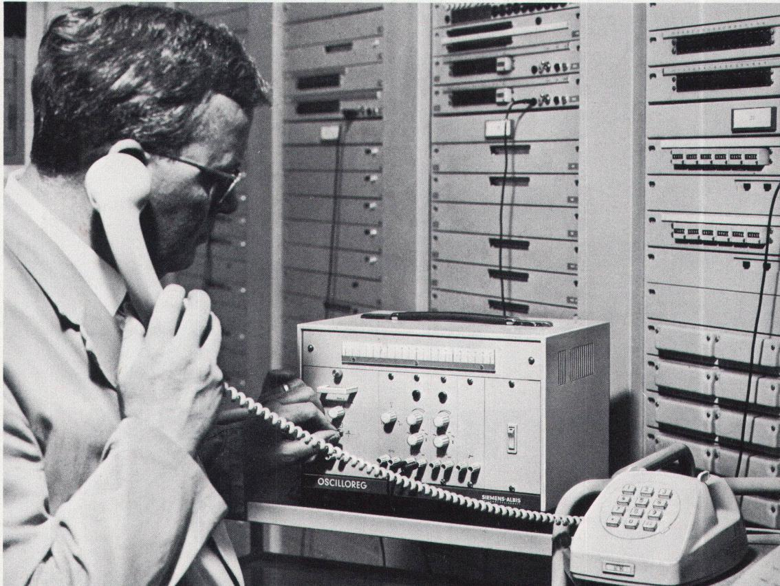
Der neue Dreikanal Metallpapier - Impulsschreiber mit optimaler Anpassungsfähigkeit - steckbare Modulbauweise - zwei Papiergeschwindigkeiten - drei Anlassarten - Auflösungsvermögen bis 1000 Hz. - leichte Auswertung der Schreibspuren hinter beleuchtetem Masstab - Signallampe für Schreibbereitschaft - Netzanschlüsse 110/125/220 V, 50/60 Hz. umschaltbar. Ausser dem zeitlichen Verhalten neutraler Kontakte können Spannungs- und Stromimpulse bis 300 V =/~/ bzw. 2 A =/~/ aufgezeichnet werden.
