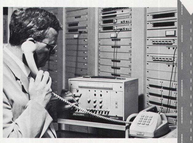
Der neue Dreikanal Metallpapier – Impulsschreiber mit optimaler Anpassungsfähigkeit – steckbare Modulbauweise – zwei Papiergeschwindigkeiten – drei Anlassarten – Auflösungsvermögen bis 1000 Hz. – leichte Auswertung der Schreibspuren hinter beleuchtetem Masstab – Signallampe für Schreibbereitschaft – Netzanschlüsse 110/125/220 V, 50/60 Hz. umschaltbar.
