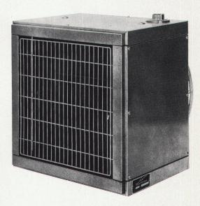
Für das schnelle und wirksame Trocknen von Wäsche ist es wichtig, dass eine rege Umwälzung von Warmluft im Trockenraum geschaffen wird. Der Warmluftapparat besteht aus einem Axialventilator mit einem drehzahlregulierbaren Motor (1x 220 V) und einem Wärmeaustauscher Epoxy behandeltem Stahlblechgehäuse eingebaut sind, sowie einem Satz Montageeisen zum Befestigen des Wäschetrockners an der Wand. Gehäuse und Montageeisen sind mit grauem Hammerschlaglack gestrichen.
