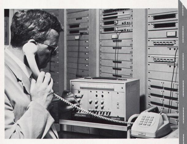
Der neue Dreikanal Metallpapier – Impulsschreiber mit optimaler Anpassungsfähigkeit – steckbare Modulbauweise – zwei Papiergeschwindigkeiten – drei Anlassarten – Auflösungsvermögen bis 1000 Hz. – leichte Auswertung der Schreibspuren hinter beleuchtetem Masstab – Signallampe für Schreibbereitschaft – Netzanschlüsse 110/125/220 V, 50/60 Hz. umschaltbar.
