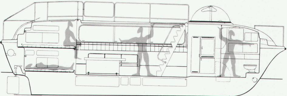
confère à l'espace une froide atmosphère neutre. Les cabines se trouvent à l'arrière. Les locaux sanitaires ont été disposés à l'avant de façon très habile. Dans l'habitacle, au milieu du bateau, le capot du moteur est utilisé comme appui du dessus de la table. ■
