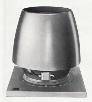
Der moderne Dachlüfter ist ein technisch hochentwickelter Abluftventilator, der sowohl in ästhetischer als auch in technischer Hinsicht alle Forderungen erfüllt. Die Abluft wird mit grosser Geschwindigkeit in einem senkrecht nach oben gerichteten Strahl ausgeblasen. Hierdurch wird eine Verschmutzung der Dachfläche vermieden. Durch sorgfältige Konstruktion sind die günstigsten Bedingungen geschaffen und damit ein sehr hoher Wirkungsgrad und ein sehr niedriger Schallpegel erzielt worden.
