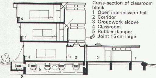
des Baus in den Hintergrund gerückt. Besondere Beachtung verdient der Schnitt durch den Klassentrakt. Die Staffelung der Klassenräume erleichtert die Beschattung der Südfassade und wurde auf der Nordseite zur Gestaltung eines besonders wirksamen Oberlichtes ausgenutzt (Abb. 2 und 3).
