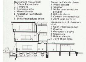
des Baus in den Hintergrund gerückt. Besondere Beachtung verdient der Schnitt durch den Klassentrakt. Die Stafflung der Klassenräume erleichtert die Beschattung der Südfassade und wurde auf der Nordseite zur Gestaltung eines besonders wirksamen Oberlichtes ausgenützt (Abb. 2 und 3).
