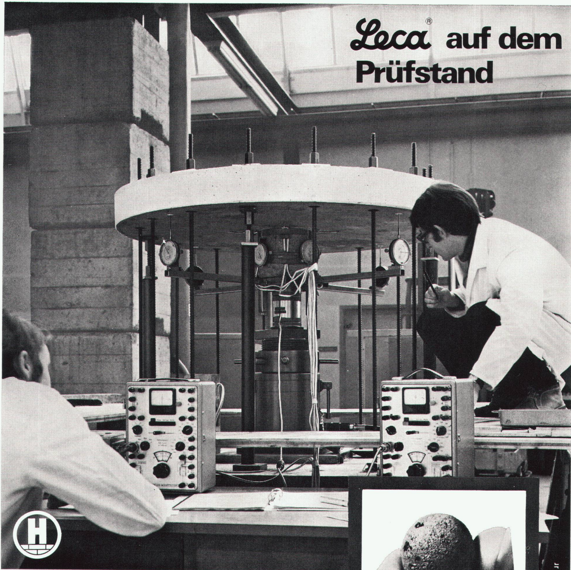
Durchstanz-Versuch an Leca hsd ® - Beton in der Eidgenössischen Materialprüfungs-Anstalt (EMPA), Dübendorf
