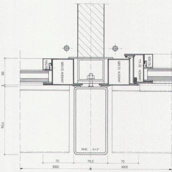
Horizontalschnitt durch Fassadenpfosten
