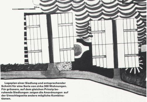
Plan de disposition d'un ensemble, et coupe correspondante, pour une série d'environ 300 appartements. Pour de plus grandes agglomérations, fondées sur le même principe. les dispositions reproduites en page de couverture montrent d'autres trames possibles.
