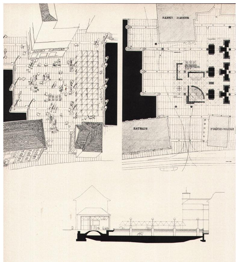
Die aus Beton vorfabrizierten zylindrischen Elemente sind als Kiosk, Kabine und als Container von technischen Installationen konzipiert. Teilweise dienen sie auch als Auflager für das Mero-Fachwerk, welches Gebiete der Brücke und das Mehrzweckgebäude überdeckt. Die Isolierung der leichten Struktur erfolgt teils durch mit Plastik beschichteten Stoffbahnen, teils durch lichtdurchlässige Glasfaser-Polyesterplatten
