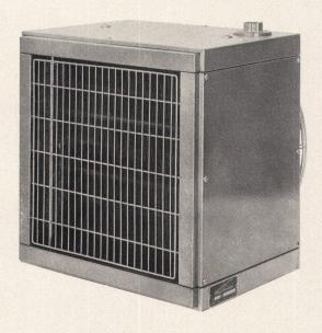
Für das schnelle und wirksame Trocknen von Wäsche ist es wichtig, daß eine rege Umwälzung von Warmluft im Trockenraum geschaffen wird. Der Warmluftapparat besteht aus einem Axialventilator mit 2 Geschwindigkeiten und einem Wärmeaustauscher für Warmwasser, welche in einem Stahlblechgehäuse eingebaut sind, sowie einem Satz Montageeisen zum Befestigen des Wäschetrockners an der Wand. Gehäuse und Montageeisen sind mit grauem Hammerschlaglack gestrichen.
