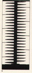
Kiesler, projet de Grand magasin, 1929. Les cinq noyaux de circulation verticale regroupent des vitrines autour des trémies d'ascenseur. Un système structural de cables sous tension et tubes télescopiques forme l'enveloppe extérieure du volume et permet la suppression des appuis intérieurs
