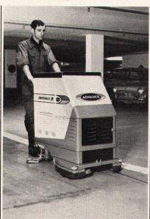
Der Industrie-Reiniger TASKI R 30 wurde **speziell für die rationelle Grossflächen-Reinigung** mit dem selbstfahrenden Feg-/Saug-Automaten TASKI CONVERTAMATIC entwickelt. (Stundenleistung bis 1300 m²!)
