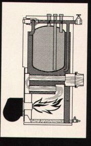
NOVOMAT ist ein vollautomatischer Stahlheiz-kessel für Oel- und Gasfeuerung
