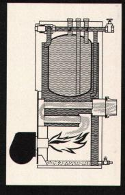
NOVOMAT ist ein vollautomatischer Stahlheiz-kessel für Oel- und Gasfeuerung
