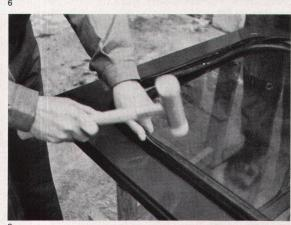
7 Bestreichen des Füllstabes mit Gleitmittel 8 Einklopfen des Füllstabes in die dafür ausgesparte Nut
