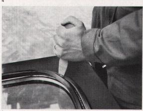
5 Fixierung der Verbundglas-Scheibe 6 Lösen der arretierten Dichtlippe mit dem Führungsgriff
