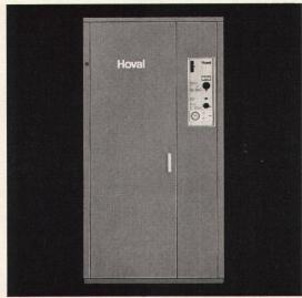
Die neuen Hoval-Automaten Typ TK-GT für Oelfeuerung und Typ TKM-A für Umstellbrand vereinigen Zentralheizungskessel, korrosionsfester Warmwasserboiler, Automatik (Raumsteuerung mit oder ohne Schaltuhr oder Aussensteuerung), Umwälzpumpe, Mischventil und Druck-Expansionsgefäss.
