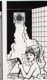
für Badezimmer, WC's, kleine Küchen usw. Saugt alle Dämpfe, unangenehme Gerüche, Dünste etc. zuverlässig ab. Der Ventilator wird einfach in eine Maueröffnung oder in ein Rohr von nur 115 mm Ø eingeschoben.
