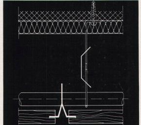
rekte Beleuchtung gewählt: an den Wänden angebrachte Beleuchtungskanäle. (Selbstverständlich kann die Beleuchtung auch in die Holzdecke eingebaut werden.)
