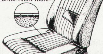
Der neue SAAB-Fahrsitz wird mit thermostatisch gesteuerten Heizelementen während der kalten Jahreszeit sofort auf eine körper-sympathische Temperatur gebracht.
