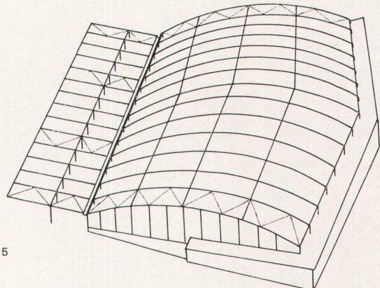
Dreizehn Binder, lamellenverleimte Zweigelenkbogen, überspannen die Eisfläche und die Tribünen der Kunsteisbahn Allmend in Bern. Zugbänder aus Stahl nehmen die Horizontalkräfte auf. Die Dachhaut selbst besteht aus lichtdurchlässigen PVC-Kunststoffwellplatten
