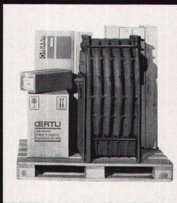
Die allseits geschlossene Brennkammer mit wassergekühltem Rost ist optimal an die Flammengeometrie angepasst. Wechselseitige Abgasführung, gleichmässige Temperaturverteilung im gesamten Kesselkörper durch strömungstechnisch günstige Querschnitte der steigenden Wasserwege und geregelte Rücklaufverteilung auf alle Kesselglieder bedeuten hohen Wirkungsgrad und damit Wirtschaftlichkeit und lange Lebensdauer.
