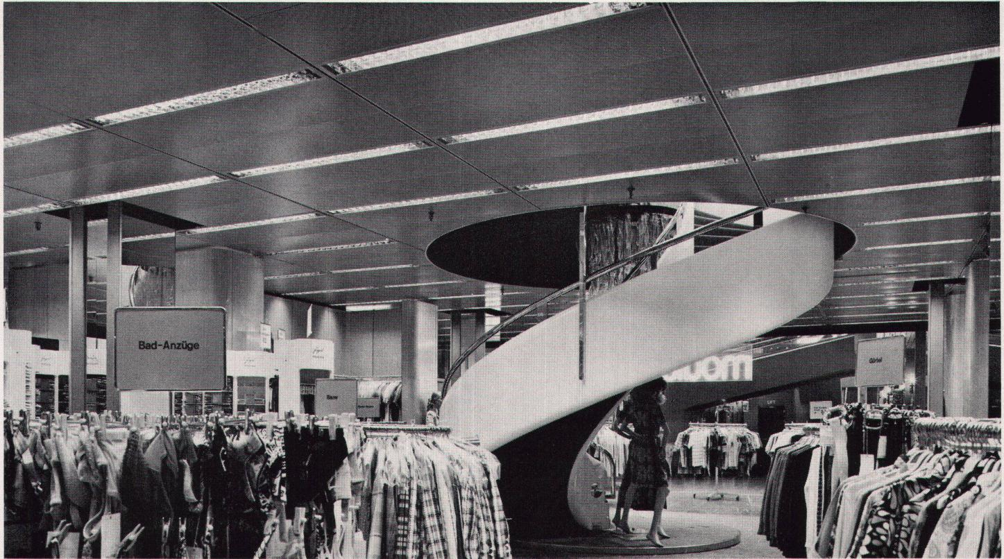
Hier – in einem Ladenraum der Firma Modissa im Einkaufszentrum Spreitenbach – wurde eine mit Stromschienen ausgestattete Gema-Metalldecke installiert.
