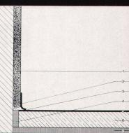
Wand-Verputz Sockelleiste Keine Verbindung! Randstreifen Roclaine-813 Bodenbelag Überbeton Roclaine-813 Rohdecke
