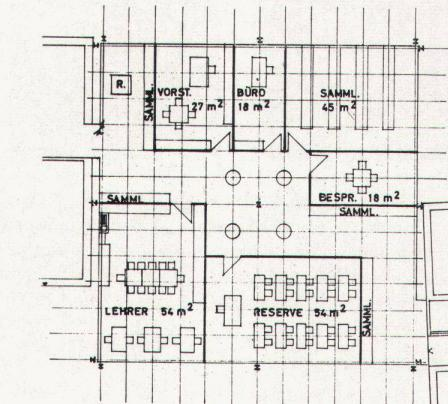
*Il s'agissait d'établir rapidement une jonction entre deux bâtiments scolaires. La construction métallique ne touche les bâtiments déjà existants qu'en deux points de structure pontée*
