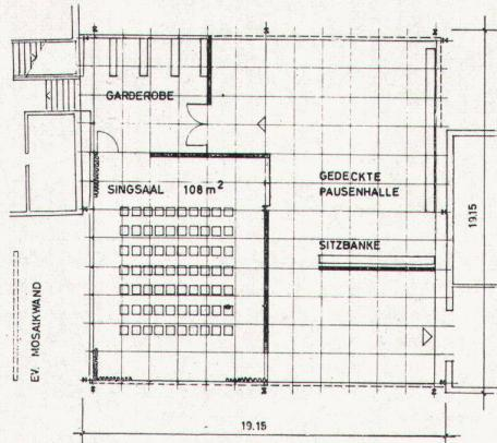
Zwei bestehende Schulhäuser mußten in kurzer Zeit durch einen Zwischenbau verbunden werden. Die Stahlkonstruktion berührt die bestehenden Bauten nur an zwei brückenartig ausgebildeten Punkten
