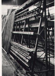
Produktions- und Montagephasen und Transport von Modular Homes. Es besteht die Tendenz, möglichst große Fabrikationsteile herzustellen; die obere Grenze ist durch die Transportvorschriften determiniert
