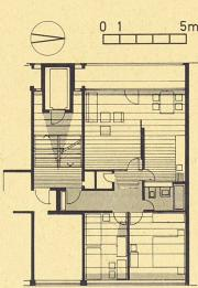
Der ganze Wohn- und Eßteil wird durch den vorgelagerten Balkon verschattet. Das Durchführen der Fenster auf ganze Raumbreiten ergibt eine regelmäßige Belichtung. Der Korridor wird durch eine Glastüre zum Wohnraum aufgehellt.
