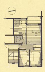
Der Balkon verschattet den Wohnraum. Die direkte Verbindung zum Eßplatz kompensiert diesen Umstand weitgehend. Der Korridor wird durch die Glastüre zum Wohnraum belichtet. Der Wohnteil erhält erst nach 12.30 Uhr direkte Sonneneinstrahlung.
