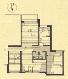
Der Wohn- und Eßteil erhält von beiden Fassadenseiten Licht. Eine gleichmäßige Raumbeleuchtung wird dadurch erreicht. Die Süd-Nordorientierung des Wohnraums bringt eine ausgezeichnete Besonnung. Der Korridor müßte direkt belichtet werden.
