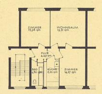
Vorteile: Doppelte Erschließung eines Schlafzimmers. Dadurch wird die alternative Benützung als Wohnraum oder als dessen Erweiterung möglich. Die gut dimensionierten Zimmer gestatten
