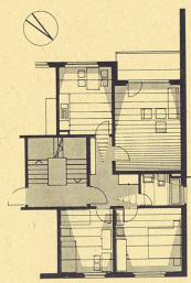
Der Wohnraum ist durch den vorgelagerten Balkon verschattet. Die fehlende direkte Verbindung vom Wohnraum zum gut belichteten Eßplatz wird hier besonders spürbar. Der Korridor erhält Licht durch die Küche und das direkt belichtete Badezimmer. Der Wohnteil erhält eine optimale Besonnung.
