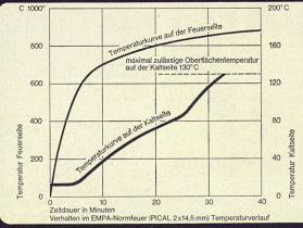
Die Isolierplatte PICAL können Sie nicht anzünden. Sie ist unbrennbar und wird deshalb am Bau als feuerhemmende Verkleidung eingesetzt.
