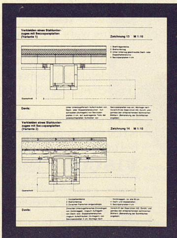
Sicherheitswert, wie die Prüfungsergebnisse auf Feuerwiderstandsfähigkeit bestätigen: SECCOPAN 2 1/2 cm  $W_F = 49$  Minuten; SECCOPAN 4 cm  $W_F = 108$  Minuten. Sie sind damit «feuerhemmende» bzw. «feuerbeständige» Bauteile. Da sie überdies sehr preisgünstig sind, sollte man mit unsicheren Verkleidungen Schluss machen. In Sicherheit wiegen kann man sich nur dann, wenn man sicher baut!
