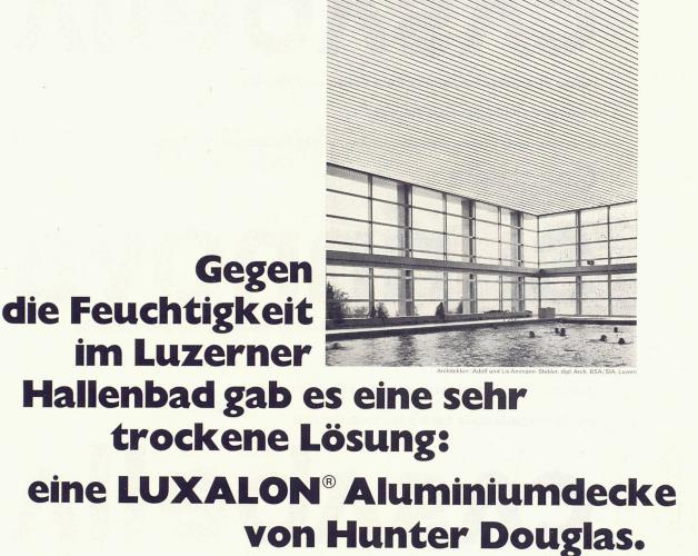
Das neue Hallenbad von Luzern hat eine LUXALON®-Akustik-Decke von Hunter Douglas. Mit Paneelen aus Aluminium. Die nicht korrodieren. Und die zusätzlich noch einbrennlackiert sind. Nach einem speziellen Hunter Douglas-Verfahren, das aus Lack mehr als Farbe macht: einen zuverlässigen, wartungsfreien Schutz, mit dem Hunter Douglas-Decken noch nach Jahrzehnten so schön sind wie heute. Auch in Räumen mit so hoher Luftfeuchtigkeit.
