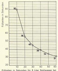
einem Fließdruck von 10 bis 60 M Wassersäule (1–6 atü) Fließdruck in atü.
