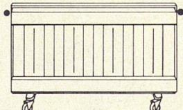
Der ölfüllte Elektroradiator als Zusatzheizung für die Übergangszeit, als lokale Vollheizung oder als ideale Ergänzung zu den Speichergeräten. Schnell aufgeheizt und problemlos regulierbar. Der Thermostat hält die gewünschte Raumtemperatur konstant. Der EOS-Direktheizer schaltet vollautomatisch ein und aus. Er ist vollkommen wartungsfrei und wirtschaftlich. Auch als Heizwand lieferbar. Diese formschönen, mobilen Direktheizer passen in jeden Raum.
