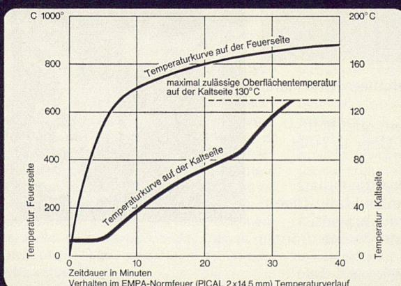
Die Isolierplatte PICAL können Sie nicht anzünden. Sie ist unbrennbar und wird deshalb am Bau als feuerhemmende Verkleidung eingesetzt.
