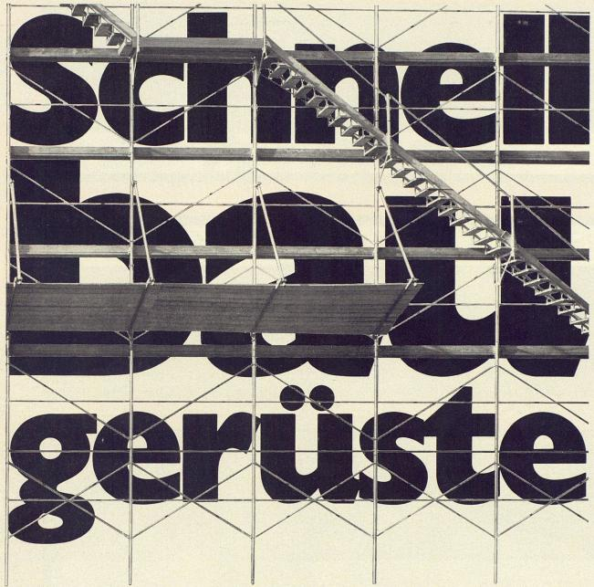
Sie kennen es: das Schnellbaugerüst, System Conrad Kern Die Rahmenbreite beträgt 65 cm, der Rahmenabstand 250 cm. Die eingebaute Gerüstplatte für den Laufgang ist 35 mm dick und imprägniert. Sie erfüllt zudem die Funktion der Horizontalverstrebung der Rahmen und ersetzt das horizontale Strebenkreuz.
