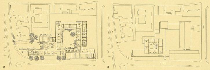
Der Hauptbaukörper besticht durch klare grundrißliche Durchbildung und den reizvollen Lichthof, um den die Klassenräume angeordnet sind. Mit 44650 m³ dürfte das Projekt eine wirtschaftliche Lösung darstellen. Das statisch-konstruktive System des Hauptbaukörpers ist sehr einfach und sauber.
